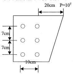
5.如圖之接頭,如採用 E70 之焊條,焊接尺寸 9mm 和 A36 鋼板,試決定容許 拉伸荷重。〈 20% 〉
