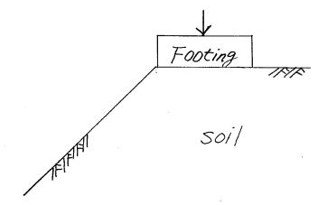
2. 如下圖所示地盤上新建一柔性條形基礎,使用年限預訂爲建造完成後 50 年, 試計算可能發生之各種沈陷。(30 分)
