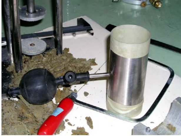
圖 7.3.11 橡皮膜安置套管
