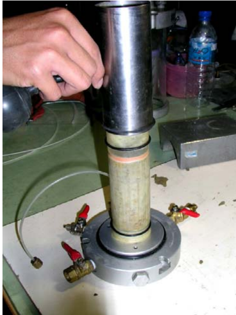
圖 7.3.13 移出橡皮膜套管
