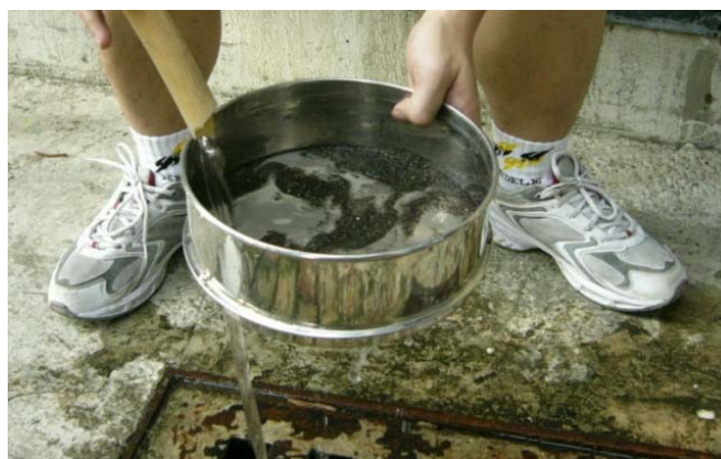
圖 3.5.13 #200 試驗篩內以水沖洗
