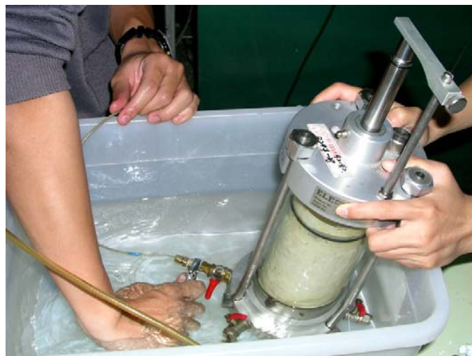
圖 7.3.16 三軸室管線與加壓面板管線連結
