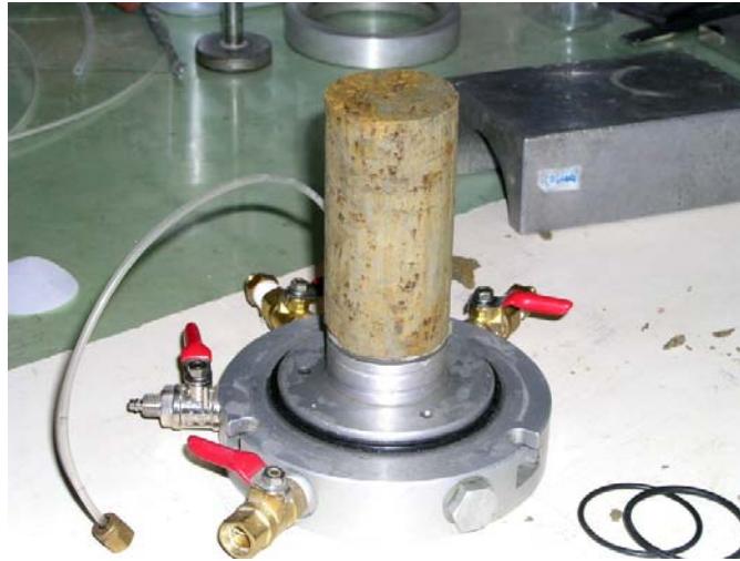
圖 7.3.9 試體放在三軸之底板濾紙上
