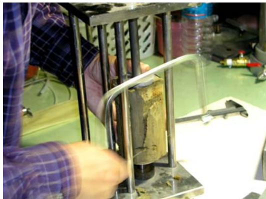
圖 7.3.5 試體移至修土器修整
