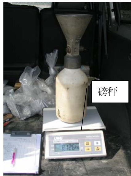
圖 4.2.7 秤砂錐儀剩餘標準砂重
