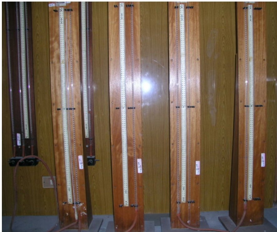
圖 5.2.1 變水頭透水試驗儀
