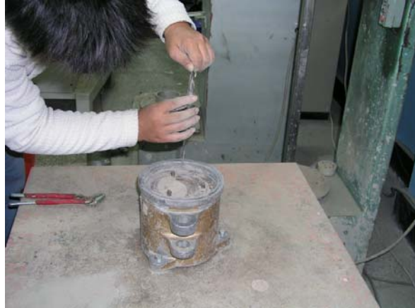
圖 3.6.17 量試模至超載重基板之深度
