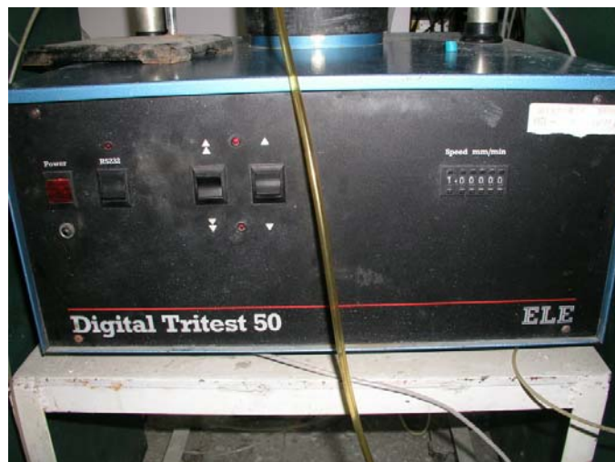
圖 7.3.19 設定垂直載重速率
