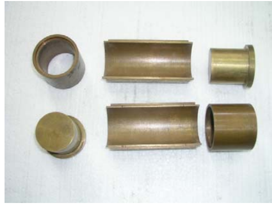
圖 7.2.3 重模試體工具
