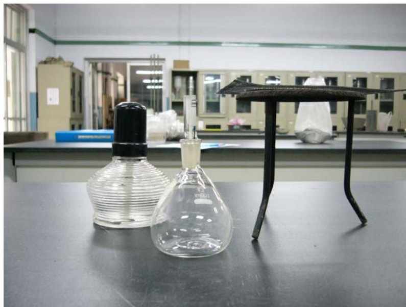
圖 3.2.1 酒精燈、比重瓶、石棉心網及腳架
