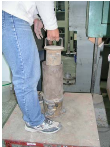
圖 3.6.15 超載重放在套筒內
