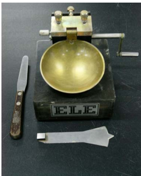
圖 3.3.2 V形劃刀及液性限度儀
