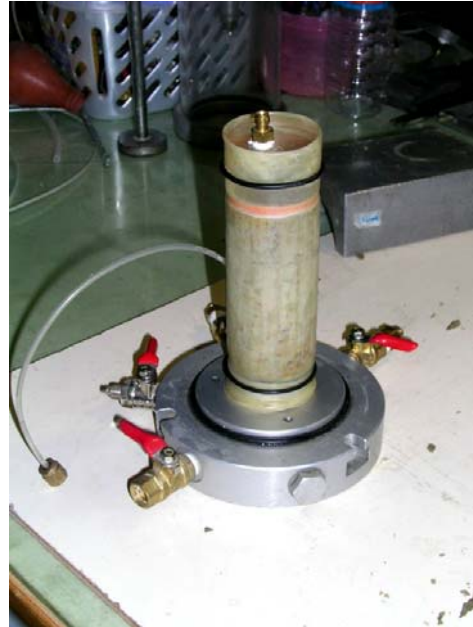
圖 7.3.14 完成圓柱形試體
