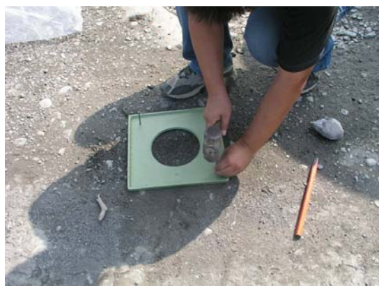
圖 4.2.3 砂錐底盤以鐵釘固定在地表
