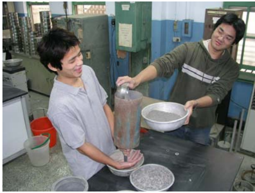
圖 3.6.7 試料放入漏斗中
