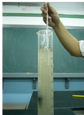
圖 3.5.12 讀取量筒比重計刻度
