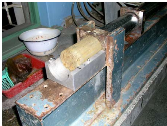
圖 7.3.4 以薄管頂土器頂取土樣
