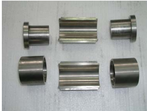
圖 7.3.2 分裂式試體重模製具
