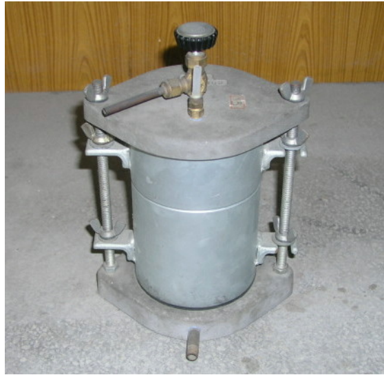
圖 5.1.2 定水頭透水試驗室
