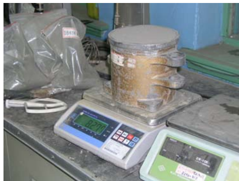
圖 3.6.11 稱試模(含試樣)重
