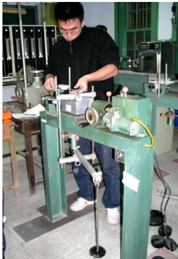
圖 7.1.9 安置水平及垂直變位測微計 圖 7.1.10 調整剪力機之齒輪及檔數
