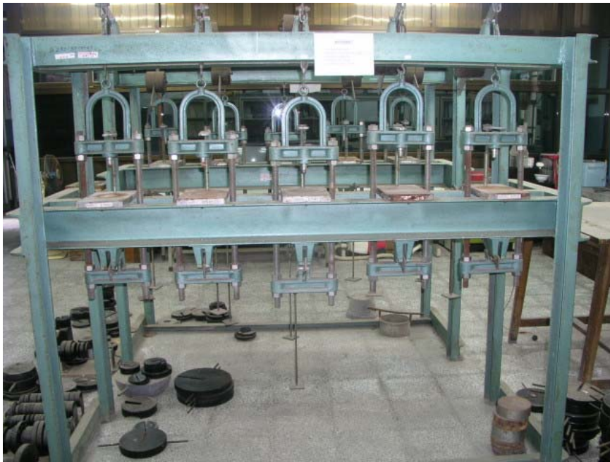
圖 6.1 土壤壓密試驗儀
