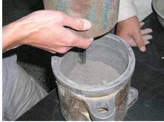
圖 3.6.8 試樣澆置新試模內
