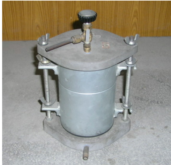
圖 5.2.2 變水頭透水試驗室
