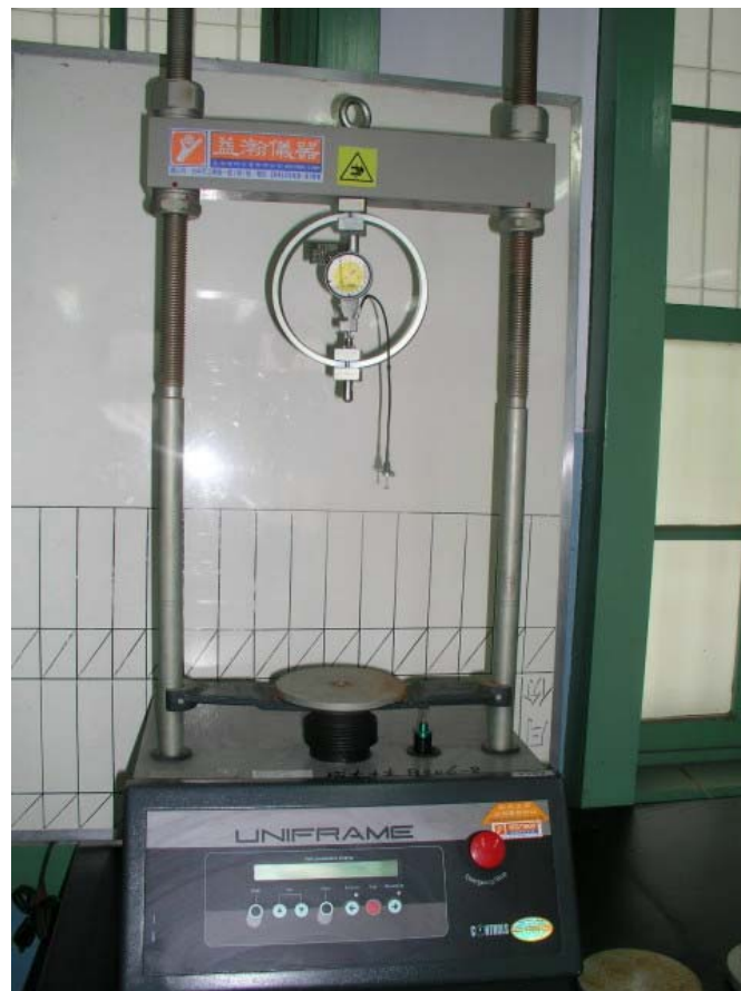
圖 7.2.1 無旁束壓縮試驗儀
