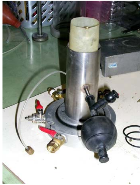
圖 7.3.12 橡皮膜套於圓柱試體
