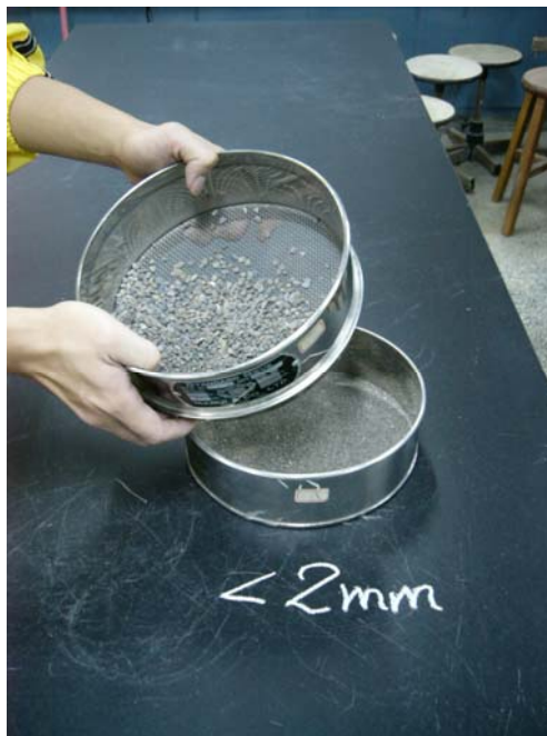
圖 3.5.9 取通過 2.0 mm 試驗篩之試樣 50 g
