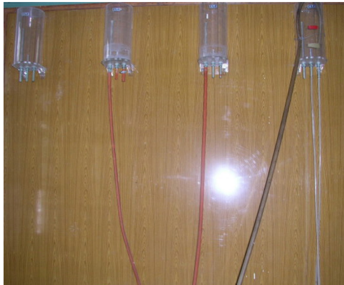
圖 5.1.1 定水頭透水試驗儀
