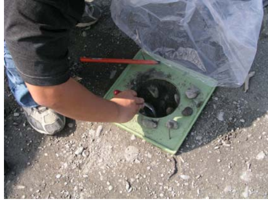
圖 4.2.5 將挖掘出之土樣放入容器內
