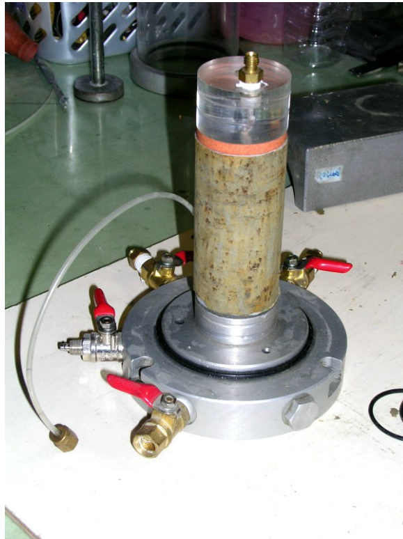
圖 7.3.10 試體頂部放上濾紙及試體承壓頂蓋
