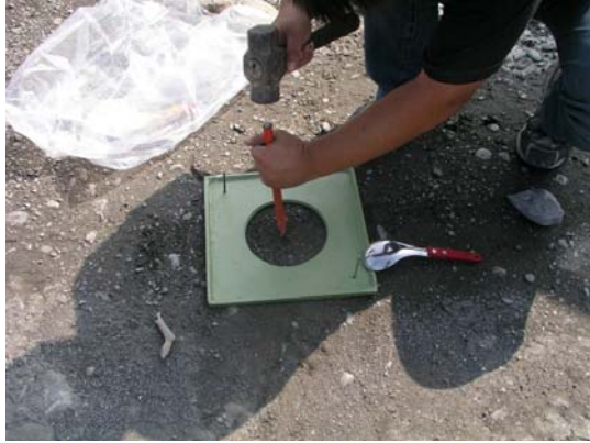
圖 4.2.4 挖取底盤開孔內之土樣
