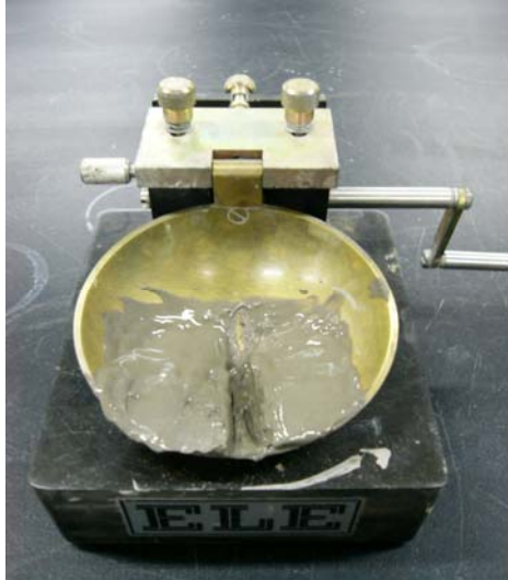
圖 3.3.4 以 V 形劃刀在土樣中央劃過
