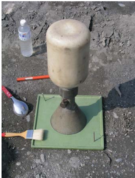
圖 4.2.6 將砂錐儀置放在底盤上
