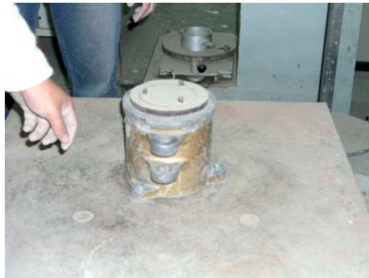
圖 3.6.13 基板厚放入試模土樣
