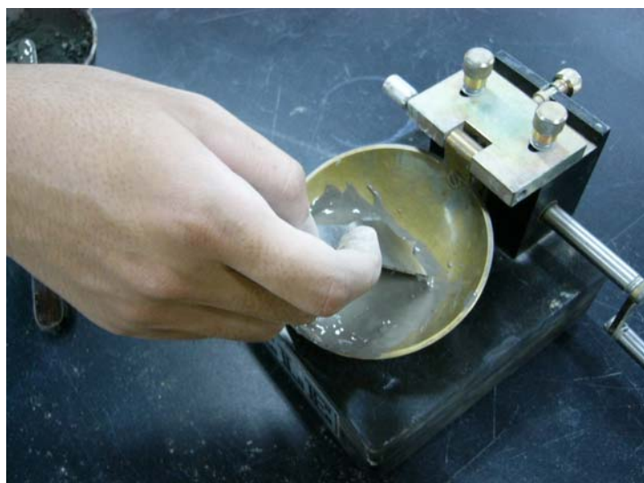
圖 3.3.3 將土壤置入杯盤中
